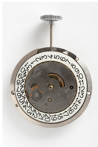
Mouvement Jeambrun PS 33 C : face côté cadran. Phot. Sonia Dourlot IVR43_20172500189NUC4A
