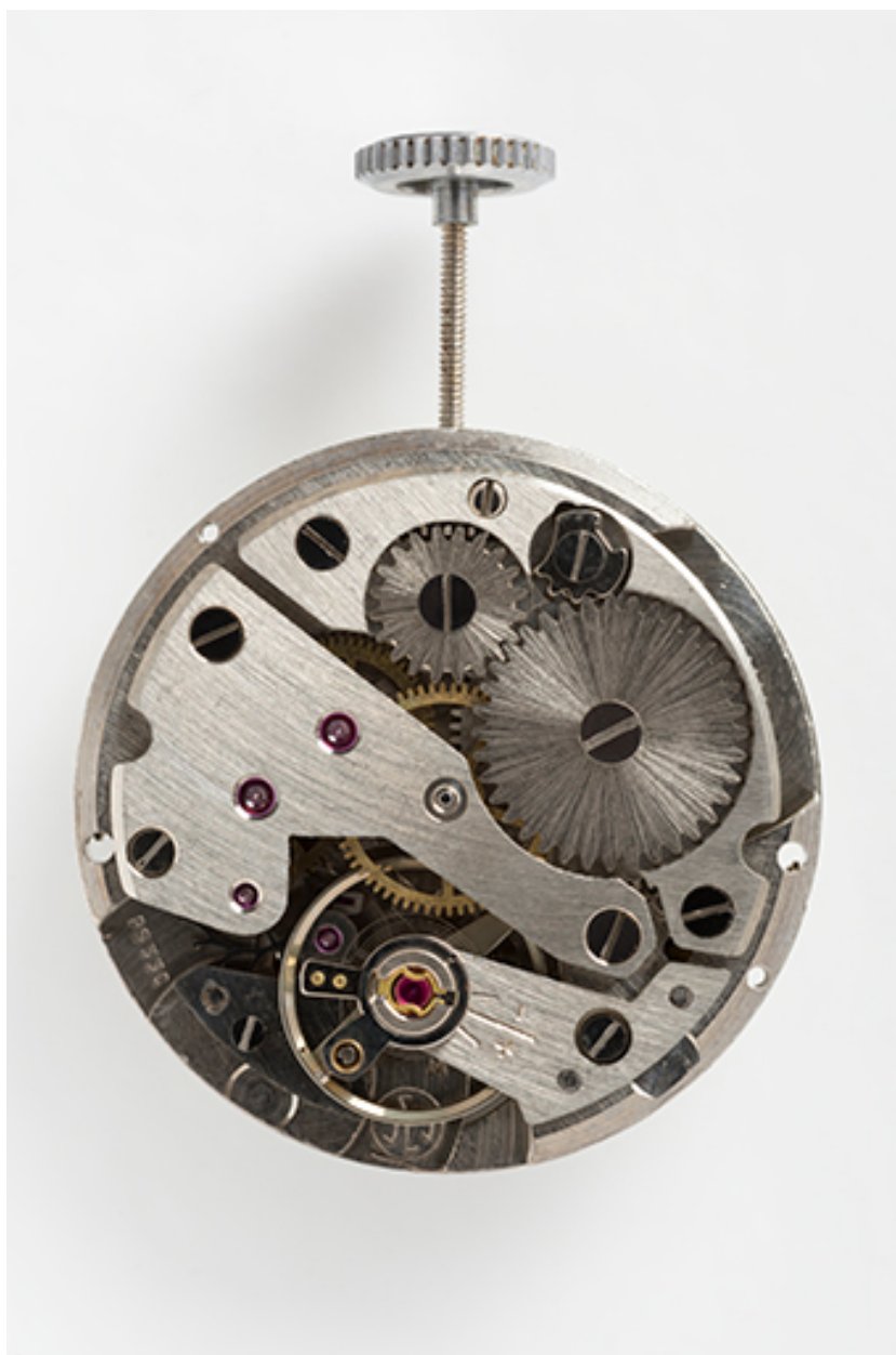
Mouvement Jeambrun PS 33 C : face côté ponts.
