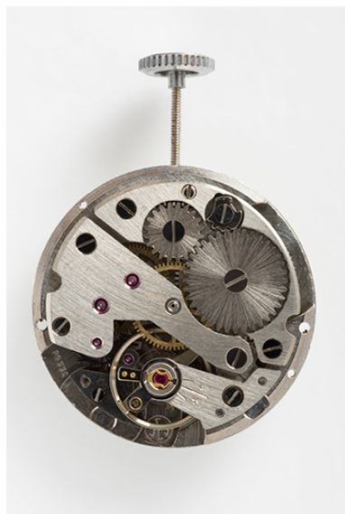
Mouvement Jeambrun PS 33 C : face côté ponts. Phot. Sonia Dourlot IVR43_20172500190NUC4A
