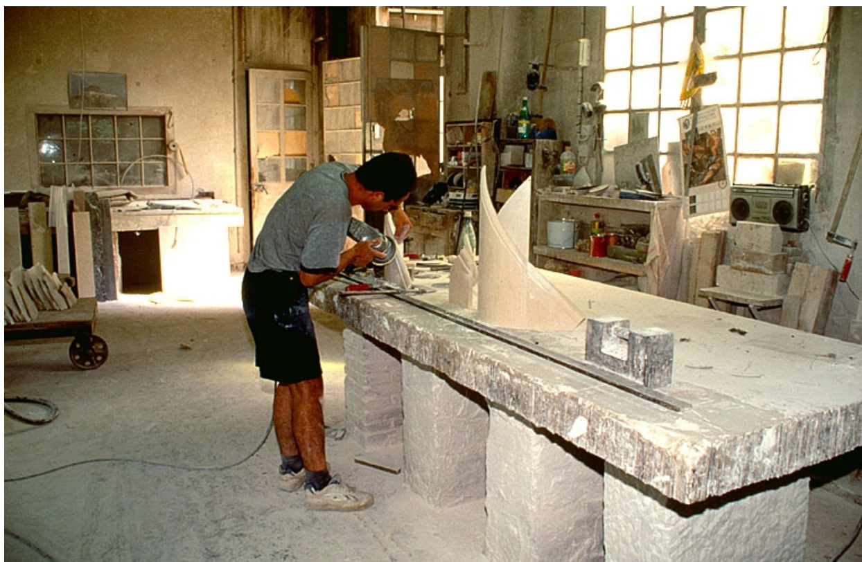
Polissage d'un limon d'escalier.
