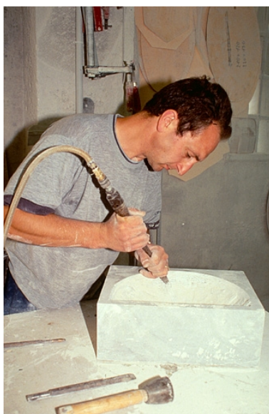
Creusage d'un lavabo. Phot. Yves Sancey IVR43_19973901791ZA
