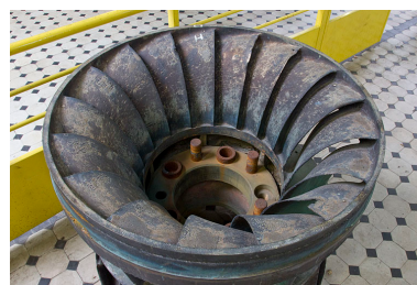
Extrémité des aubes de la roue d'une turbine Francis double. Phot. Yves Sancey IVR43_20122502138NUC2A
