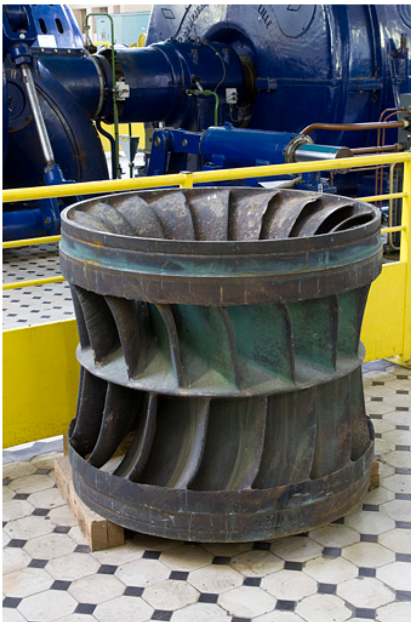
Roue d'une turbine Francis double.
