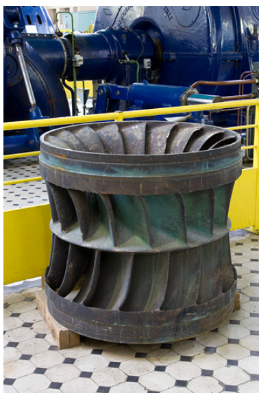
Roue d'une turbine Francis double. Phot. Yves Sancey IVR43_20122502131NUC2A
