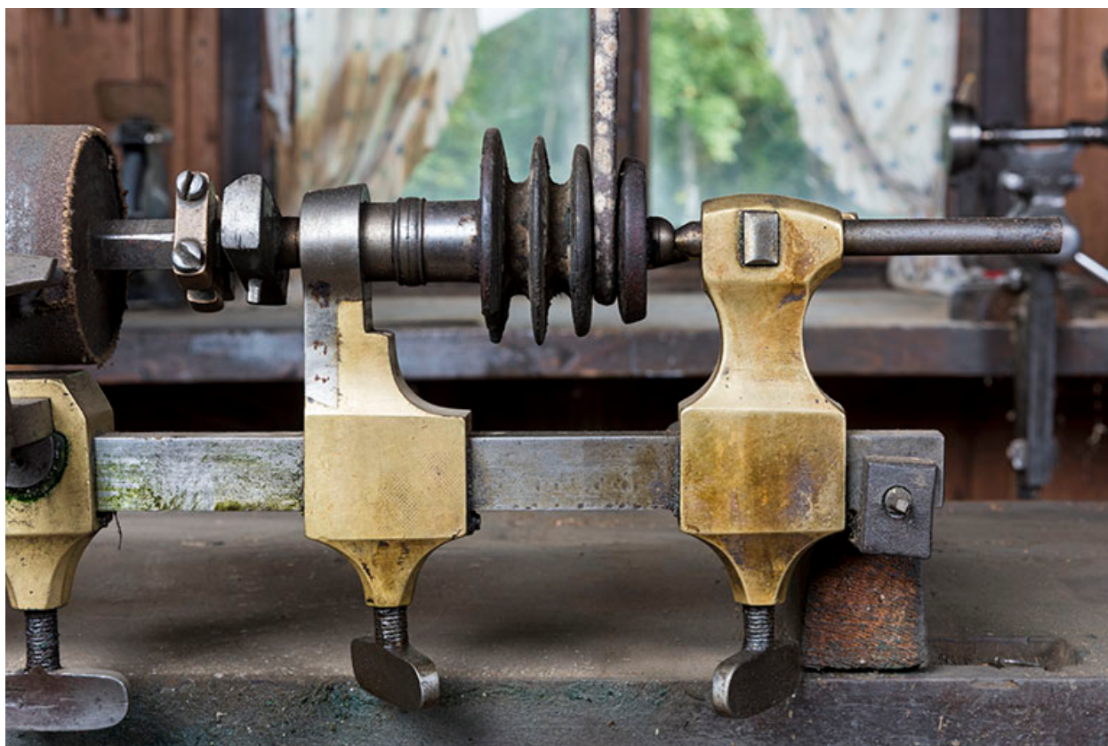
2e tour (machine à polir) : poupée mobiles avec l'arbre moteur et sa poulie.
