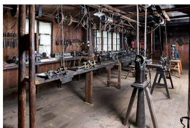
Vue d'ensemble de l'atelier, avec deux des tours à perche au premier plan à gauche.
