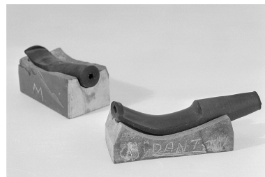
Détail de deux tuyaux en ébonite moulés dans leur marbres. Phot. Jérôme Mongreville IVR43_20022500942X
