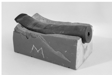
Détail d'un second tuyau en ébonite moulé dans son marbre. Phot. Jérôme Mongreville IVR43_20022500939X
