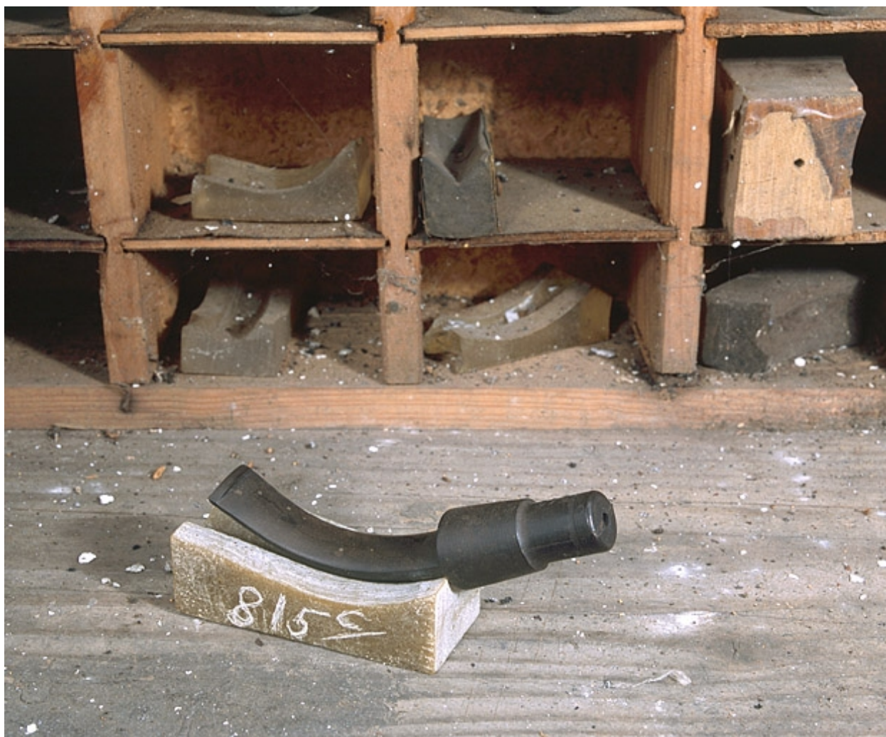
Tuyau en ébonite dans son marbre.
