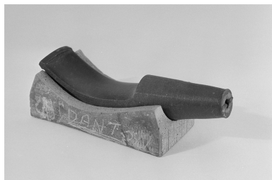
Détail d'un premier tuyau en ébonite moulé dans son marbre. Phot. Jérôme Mongreville IVR43_20022500940X
