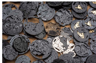
Composants fabriqués à l'usine : platines de montre.
