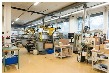
Atelier d'injection : les anciennes presses. Phot. Sonia Dourlot IVR43_20162501230NUC4A
