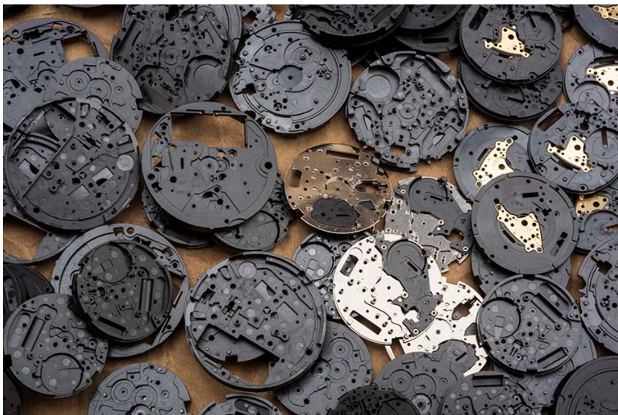
Composants fabriqués à l'usine : platines de montre.
