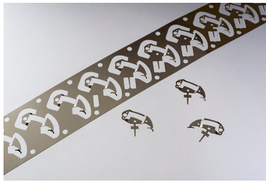
Exemple de composant et bande de matière, montrant les étapes successives de découpe à l'aide d'une étampe progressive.
