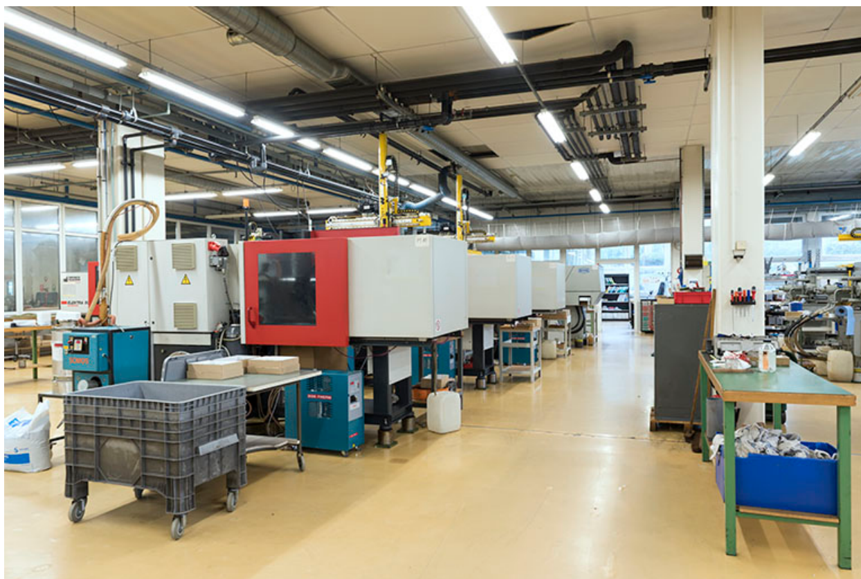
Atelier d'injection : les nouvelles presses.
