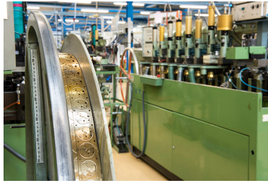
Atelier d'usinage : bande de laiton usinée.
