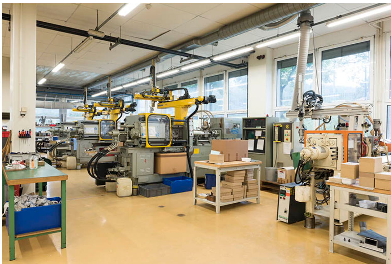
Atelier d'injection : les anciennes presses.
