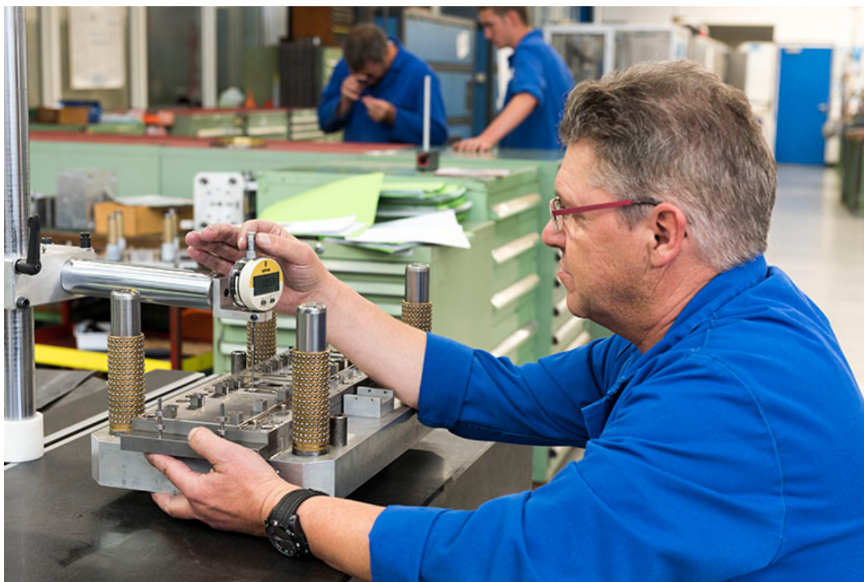
Atelier de fabrication de l'outillage : contrôles sur une étampe progressive.
