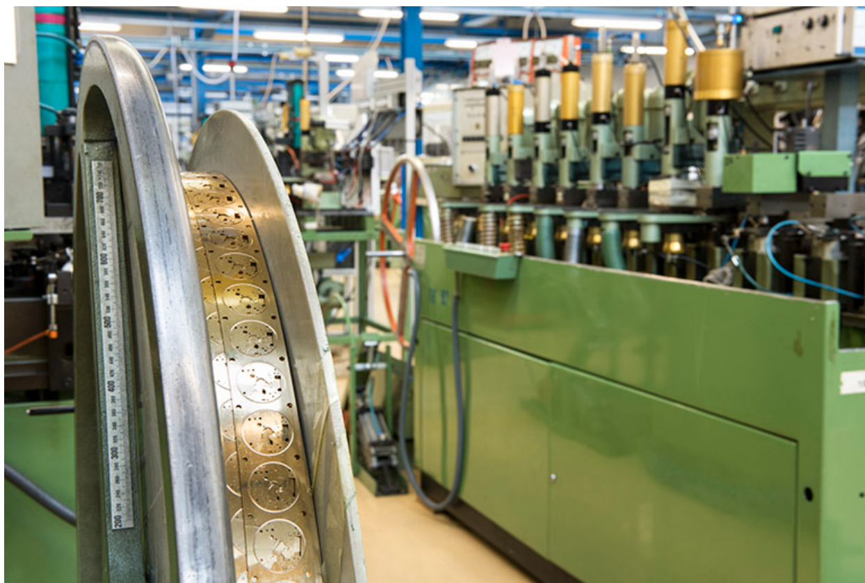
Atelier d'usinage : bande de laiton usinée.
