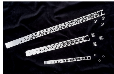
Exemple de composants fabriqués dans l'usine : bandes de matière sorties d'une presse à étampe progressive avec, à droite, les composants découpés.
