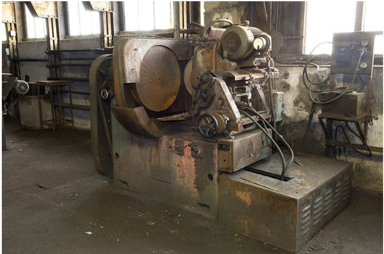
Rectifieuse de lames de scie, dite machine à planer Engeländer et Beyer (Remscheid).
