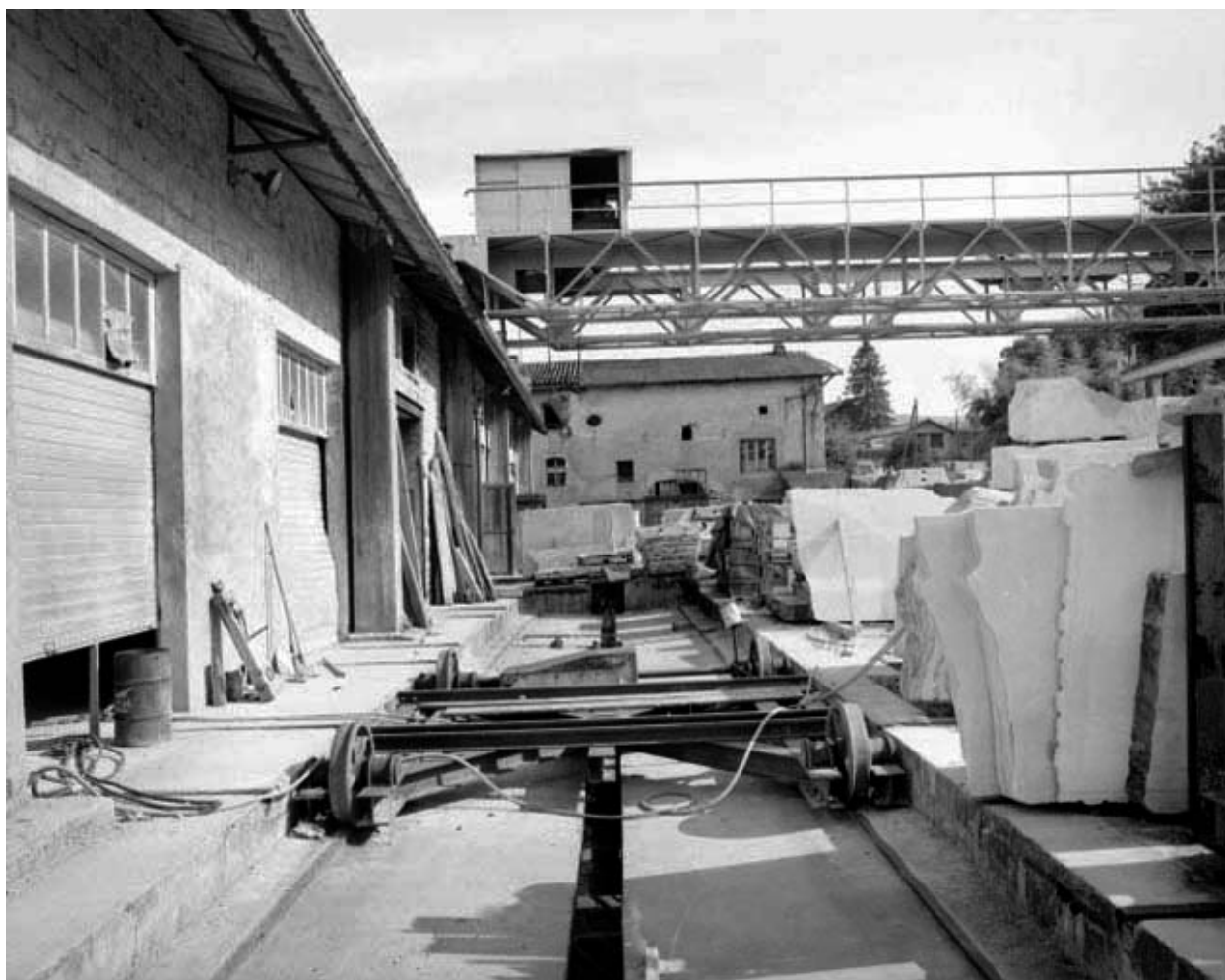
Chariot desservant l'atelier de fabrication.
