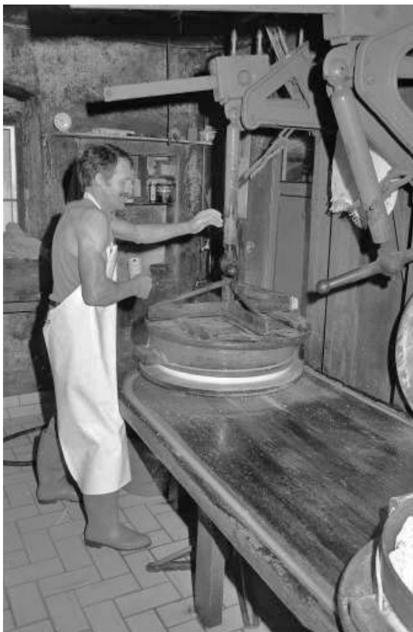
Fabrication du comté : serrage de la presse.
