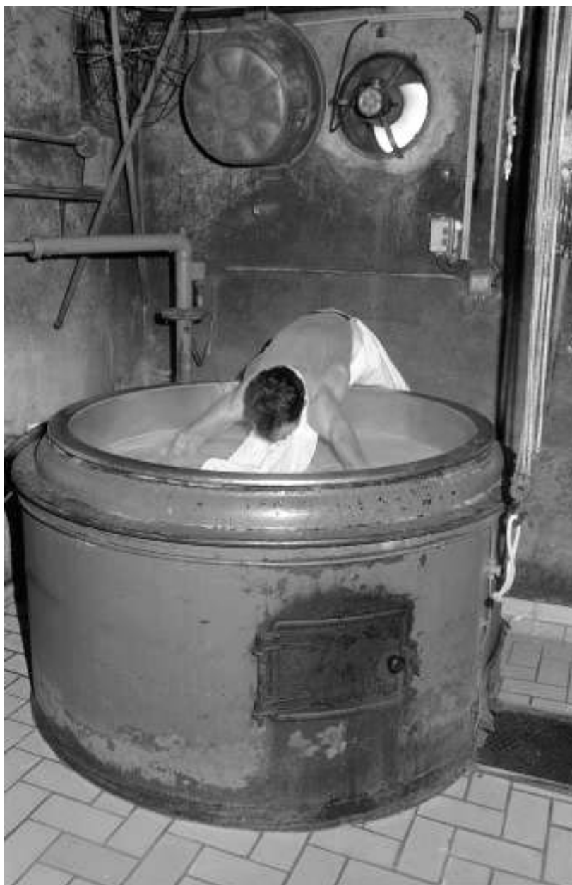
Fabrication du comté : ramassage du caillé dans la toile.
