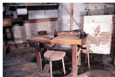
Banc à poinçonner. Phot. Yves Sancey IVR43_19913900763ZA
