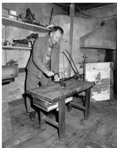
Poinçonnage d'une lame. Phot. Yves Sancey IVR43_19913900787X
