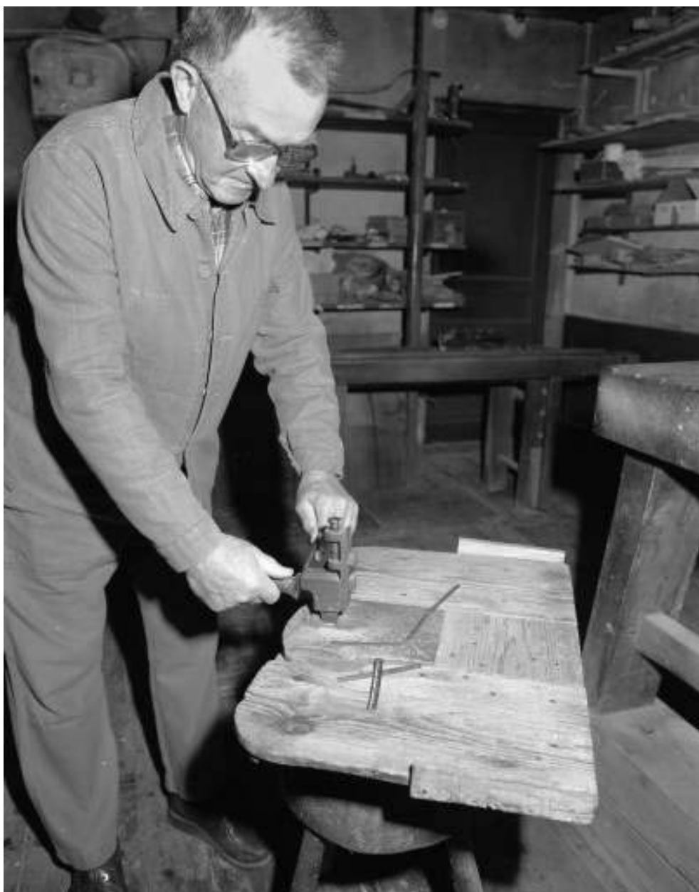
Mise au gabarit du "clou".
