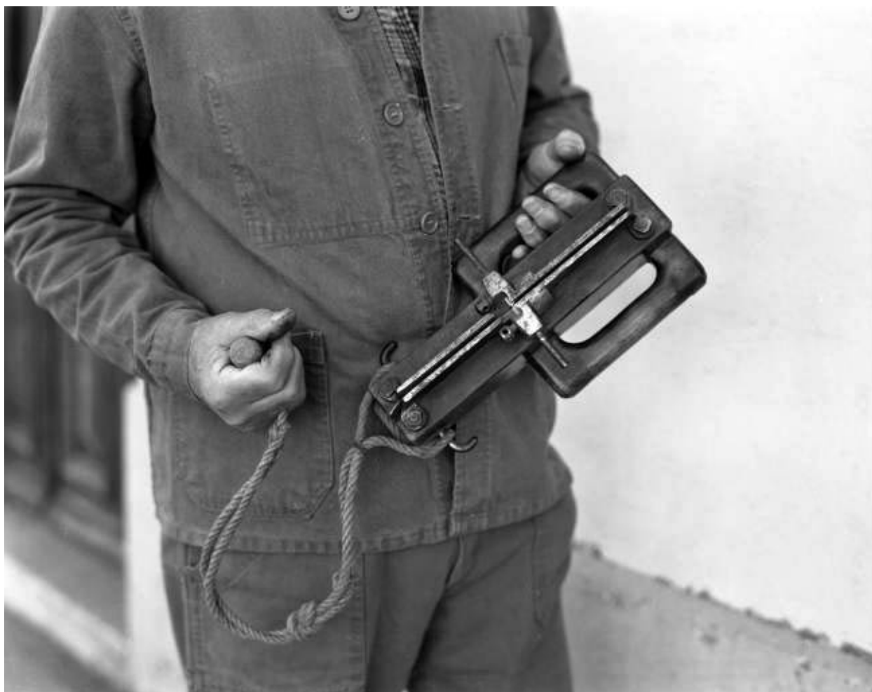
Rabot" à découper, face inférieure.
