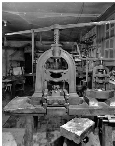
Détail de la grande presse à vis à balancier et de son poinçon.
