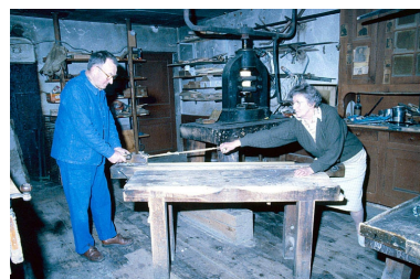
Découpage d'une bande de métal. Phot. Yves Sancey IVR43_19913900774ZA
