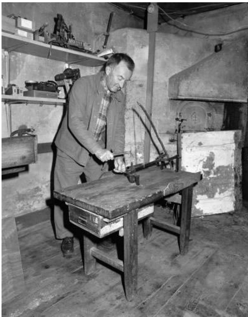
Poinçonnage d'une lame.
