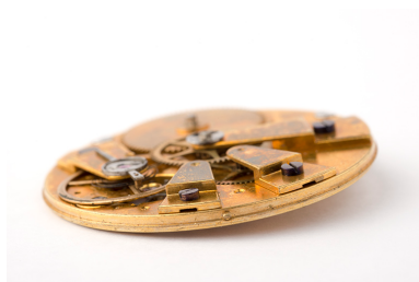
Ebauche vue de profil, avec les ponts sur sa face supérieure. Phot. Sonia Dourlot IVR43_20152500254NUC4A
