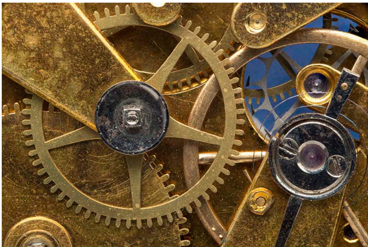
Détail de la face côté ponts : roue des minutes à gauche, balancier-spiral et raquette à gauche.
