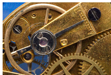
Détail de la face côté ponts : balancier-spiral, coq et raquette. Phot. Sonia Dourlot IVR43_20152500257NUC4AQ
