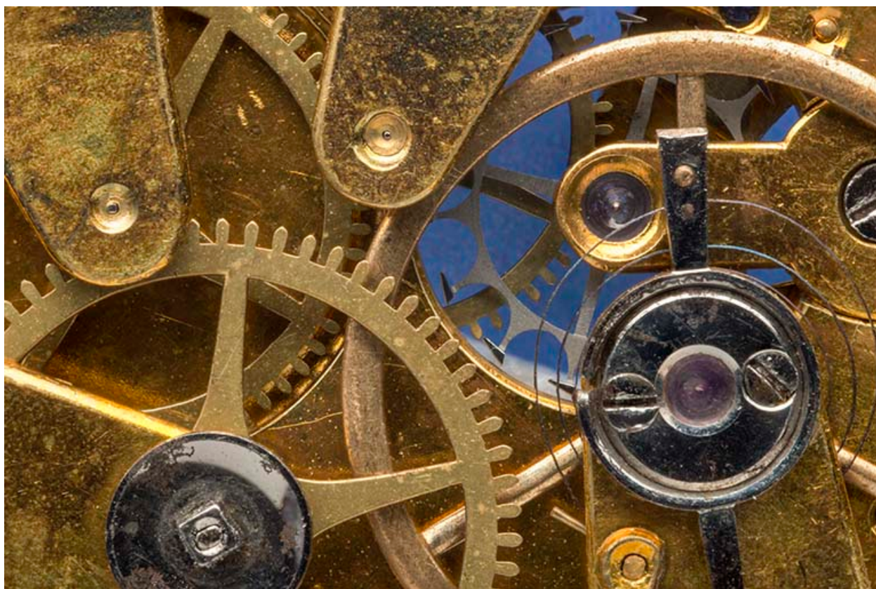
Détail de la face côté ponts : roue des minutes à gauche, balancier-spiral et raquette à gauche (vue rapprochée).
