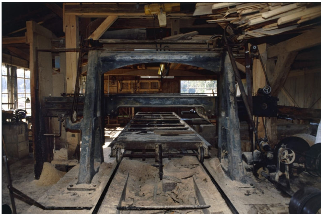
Châssis de scie et son chariot.
