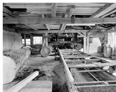
Chariot du châssis de scie. Phot. Yves Sancey IVR43_19999000183X
