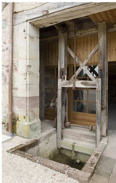
Vestiges du châssis du haut-fer. Phot. Jérôme Mongreville IVR43_20097000520NUC2A
