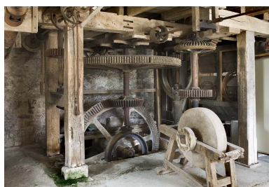
Beffroi du moulin, avec ses transmissions par engrenages. Phot. Jérôme Mongreville IVR43_20097000516NUC2A
