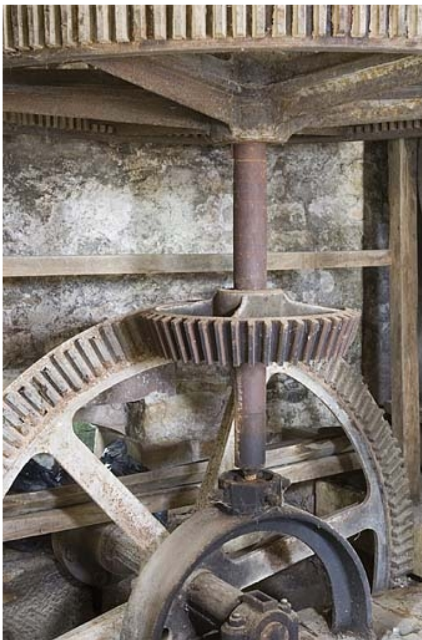
Détail des engrenages du beffroi.
