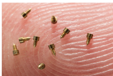
Exemple de composants fabriqués à l'usine : vis destinées au balancier de montre.
