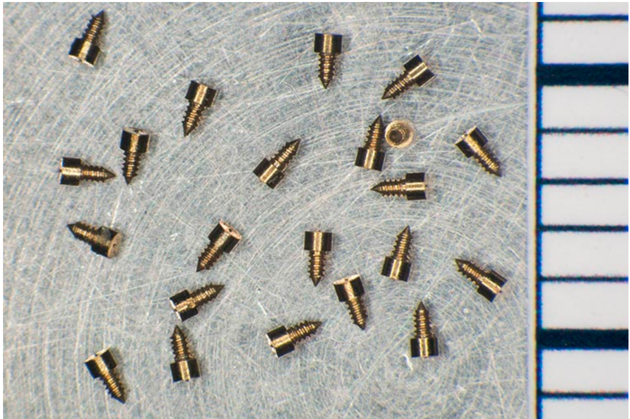
Exemple de composants fabriqués à l'usine : vis destinées au balancier de montre (avec échelle centimétrique).
