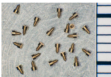
Exemple de composants fabriqués à l'usine : vis destinées au balancier de montre (avec échelle centimétrique).
