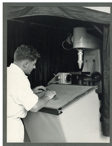
Technicien au travail sur un projecteur de profil Isoma, années 1960. IVR43_20182500795NUC4A
