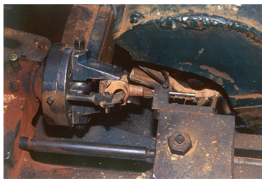
Mandrin gueule de loup et fraise verticale, vue de face en plongée. Phot. Jérôme Mongreville IVR43_20003901055ZA
