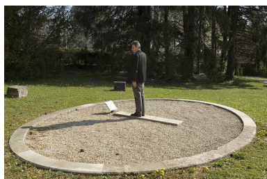
Vue d'ensemble rapprochée, après restauration. L'ombre de la personne positionnée sur le signe zodiacal correspondant à la période de l'année indique l'heure.
