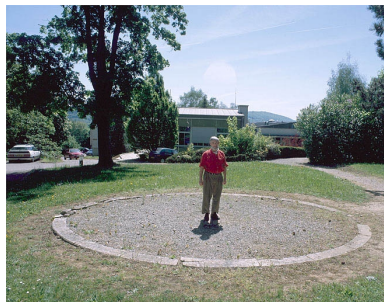
Vue d'ensemble, avant restauration. L'ombre de la personne positionnée sur le signe zodiacal correspondant à la période de l'année indique l'heure.
