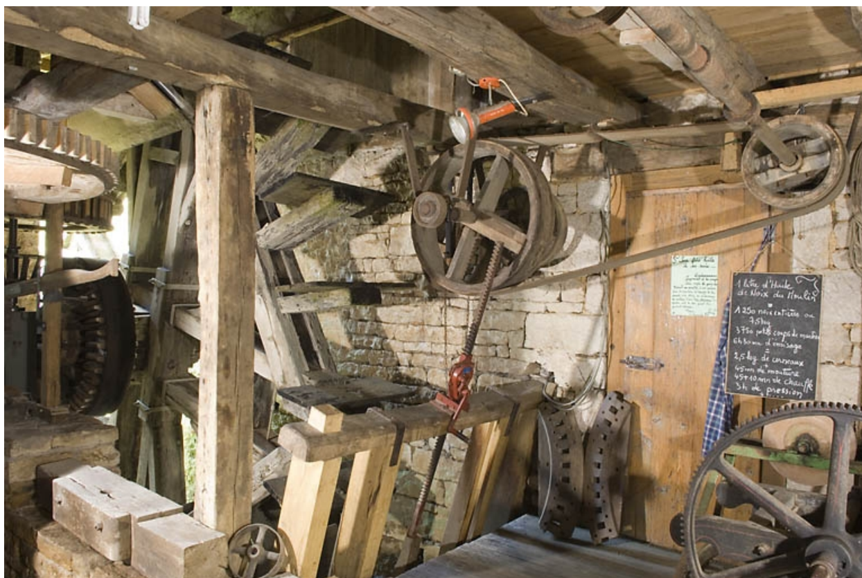
Atelier de fabrication. Roue hydraulique et transmissions.
