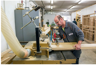
Atelier de 1990 : tenonneuse. Phot. Yves Sancey IVR43_20132501539NUC2A
