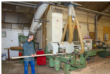
Atelier des années 1980 : raboteuse Profimat. Phot. Yves Sancey IVR43_20132501545NUC2A
