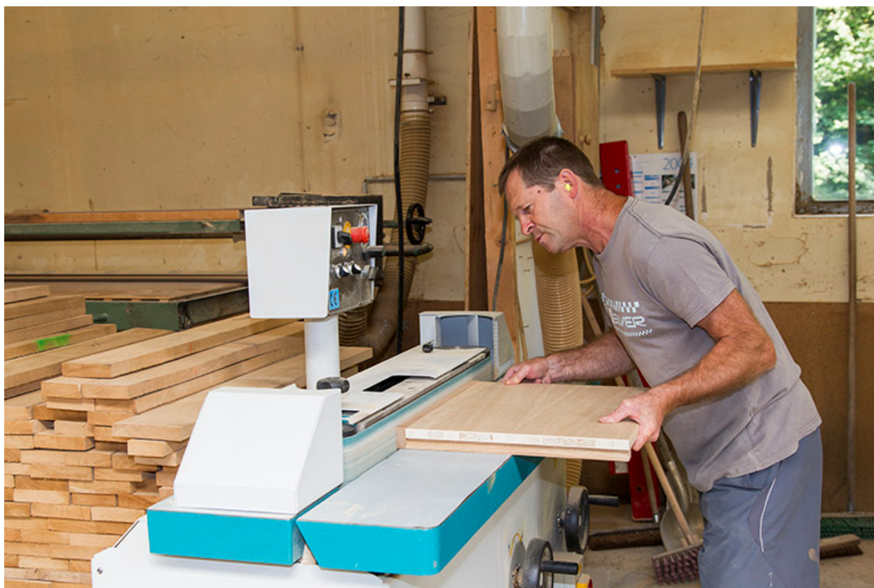
Atelier des années 1980 : ponceuse de chant Griggio.
