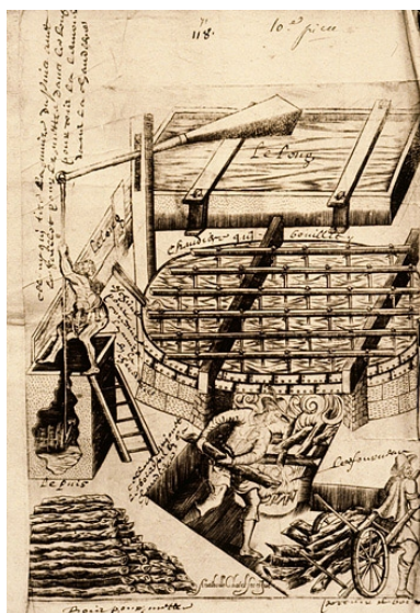
Chaudière pour l'évaporation de la saumure à la saline de Salins, [début 17e siècle] Phot. Jérôme Mongreville, Autr. Anatole Chastel IVR43_19943900105ZA
