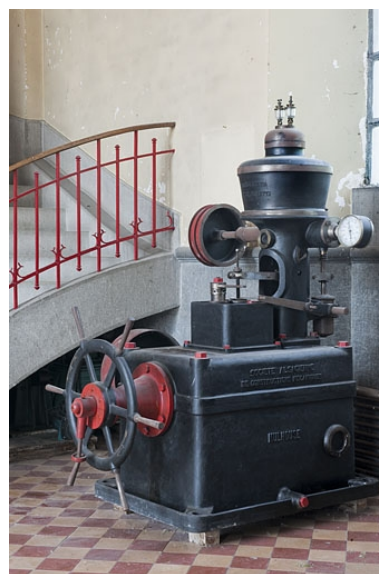
Détail d'un régulateur de la Société Alsacienne de Constructions Mécaniques (hors-service). Phot. Jérôme Mongreville IVR43_20122501783NUC4A
