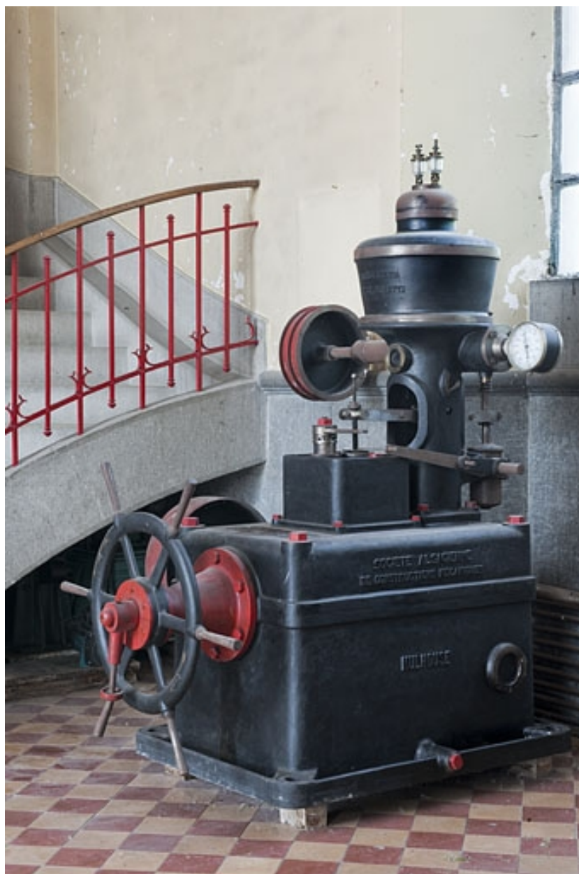
Détail d'un régulateur de la Société Alsacienne de Constructions Mécaniques (hors-service).
