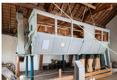
Troisième étage. La bluterie. Phot. Jérôme Mongreville IVR43_20162500269NUC4A
