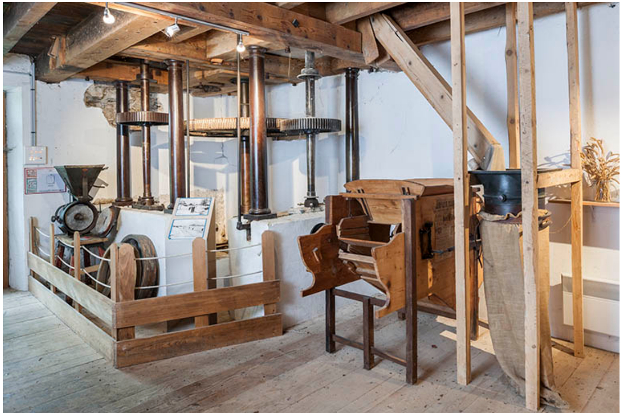
Rez-de-chaussée. Beffroi des meules.
