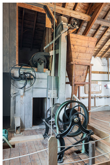
Deuxième étage. Silo, trémie et treuil du monte-sac. Phot. Jérôme Mongreville IVR43_20162500271NUC4A
