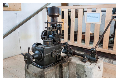
Rez-de-chaussée. Régulateur (SACM) de la turbine Laurent et Collot. Phot. Jérôme Mongreville IVR43_20162500280NUC4A
