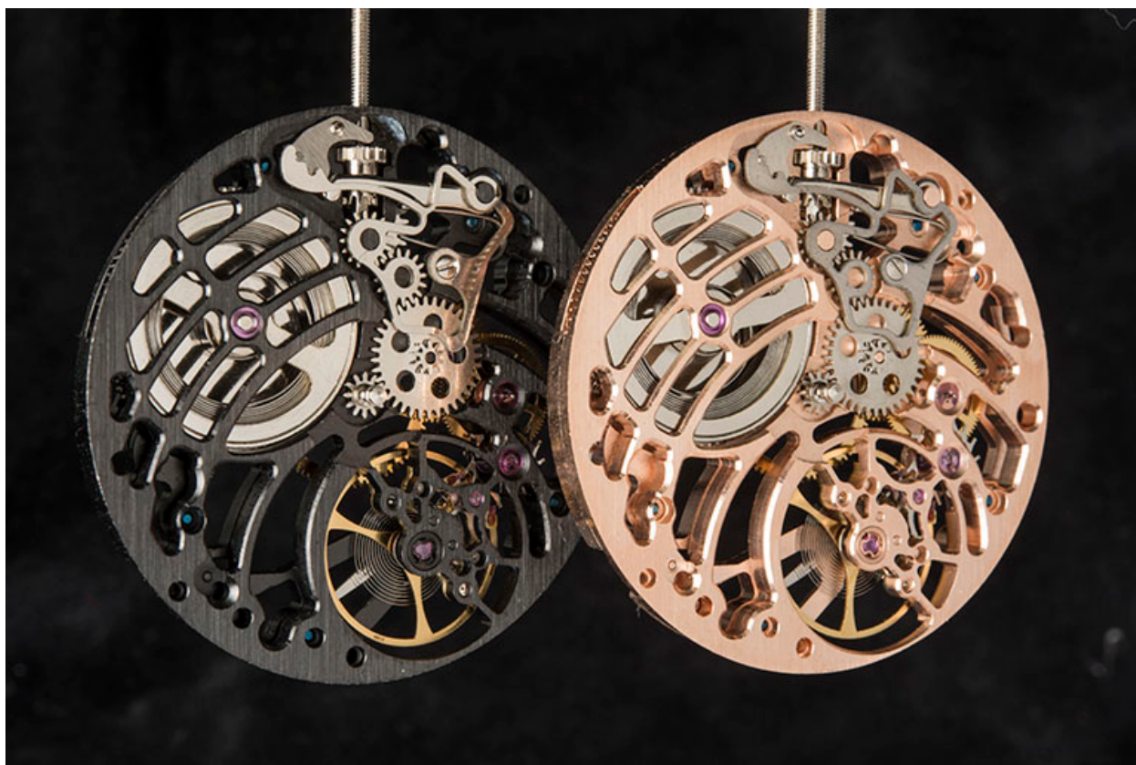
Deux mouvements squelette (Unitas 6498 avec squelettage Arte).
