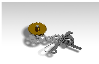
Système de mise à l'heure, tige tirée. Dess. William Berthet IVR43_20202500250NUC4A
