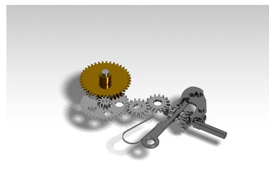
Système de mise à l'heure. Dess. William Berthet IVR43_20202500249NUC4A
