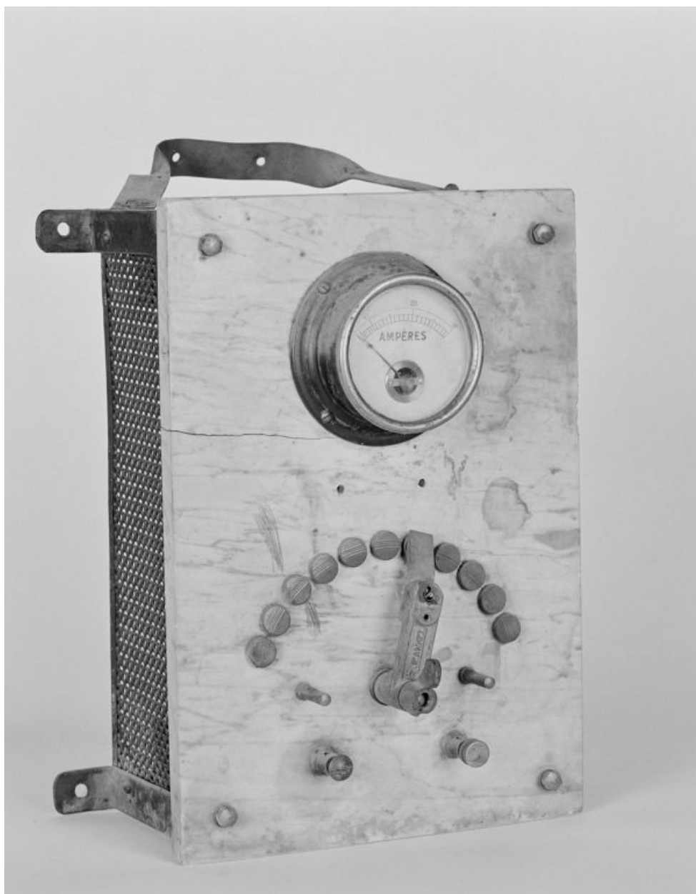
Accessoire d'éclairage, 1988 : rhéostat (transformateur).
