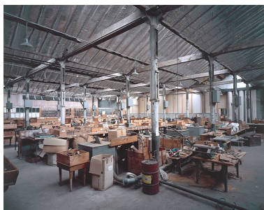
Partie ouest de l'atelier de fabrication de pipes. Les poteaux de fonte conservent la trace des
