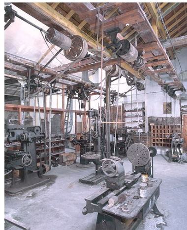
Atelier de mécanique. Détails de distribution par courroies verticales et par renvois. Phot. Yves Sancey IVR43_20022500817XA
