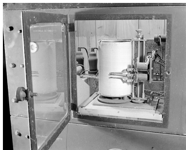
Diapason étalon : dispositif d'enregistrement de la température. Phot. Jérôme Mongreville IVR43_20032501053X
