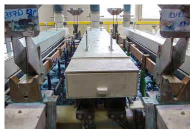
Site ancien : détail de la chaîne de chromage. Phot. Yves Sancey IVR43_20132502461NUC2A
