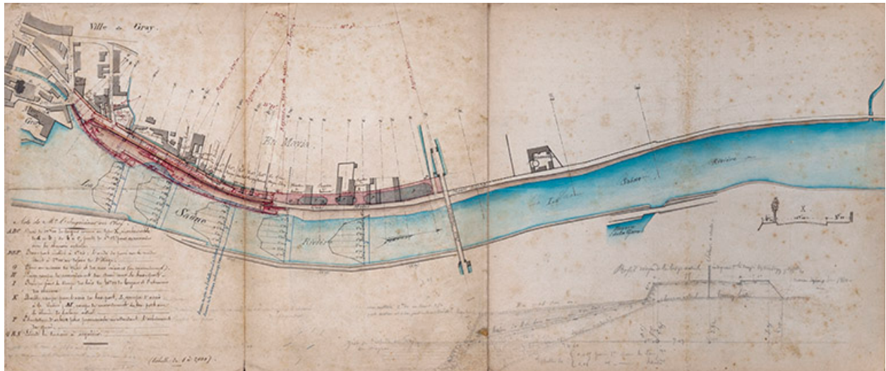
Construction d'un quai avec bas-port sur la rive gauche de la Saône en aval du moulin de Tramoy - Plan parcellaire (1866).
