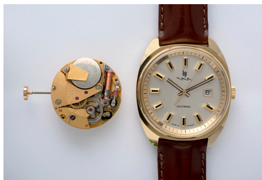
La montre côté cadran à côté d'un mouvement Lip R 184, vu côté ponts. Phot. Sonia Dourlot IVR43_20152502586NUC4A
