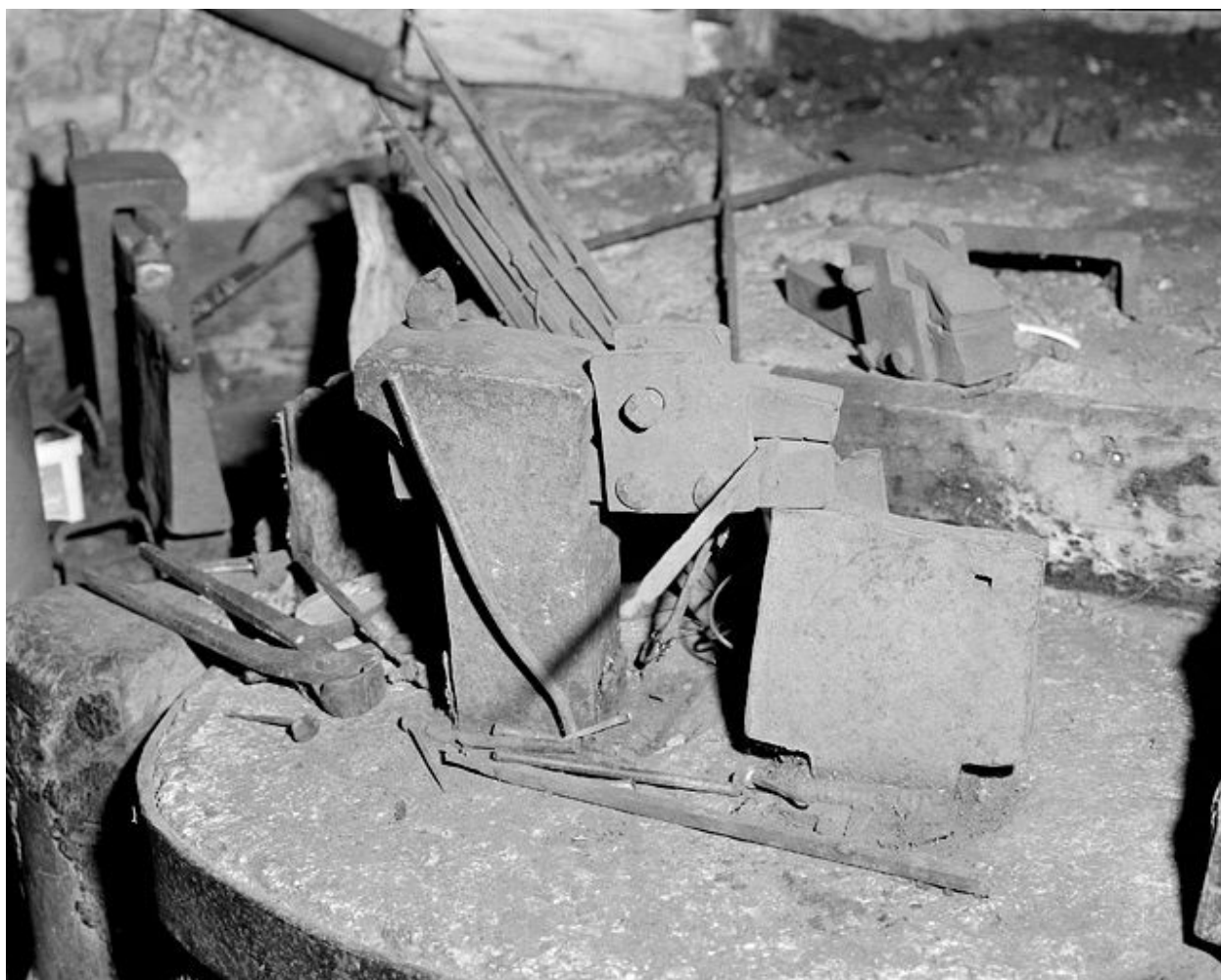
Poste de travail équipé avec une " cloutière ".
