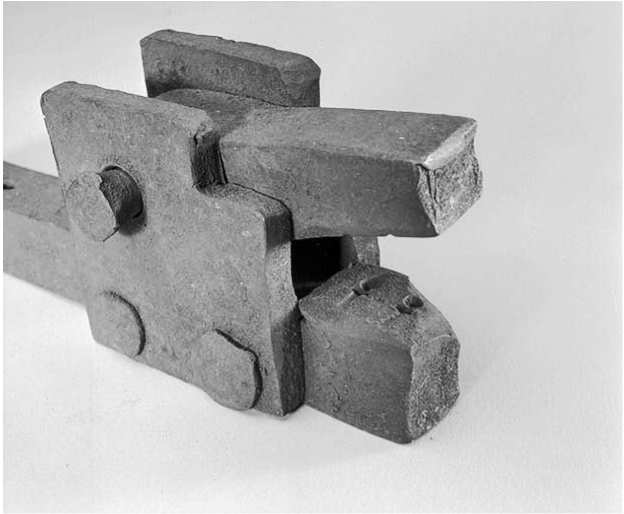
Cloutière : détail de la matrice pour les pointes de toupies.
