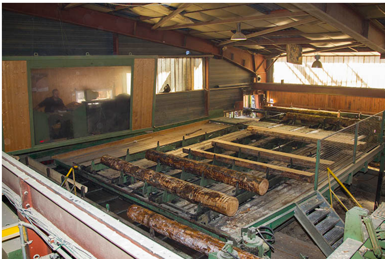
Atelier de débitage (N) : poste de commande et convoyeur de grumes.
