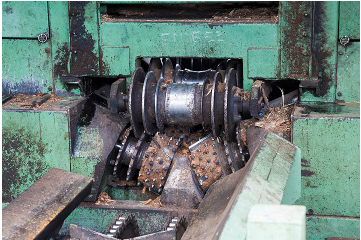
Installation de billonnage : détail des rouleaux.
