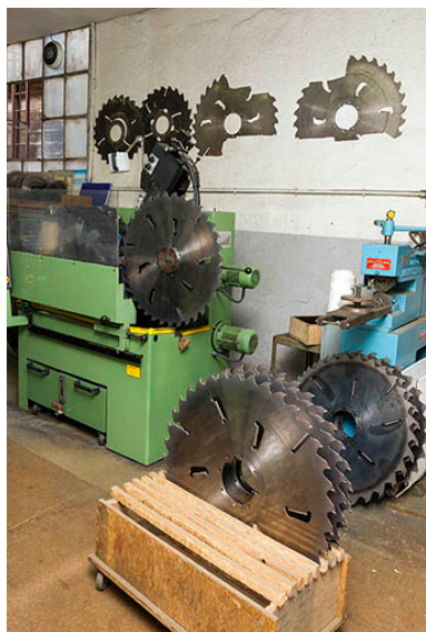
Atelier d'affûtage (K) : machine pour l'affûtage des lames de scie circulaire.
