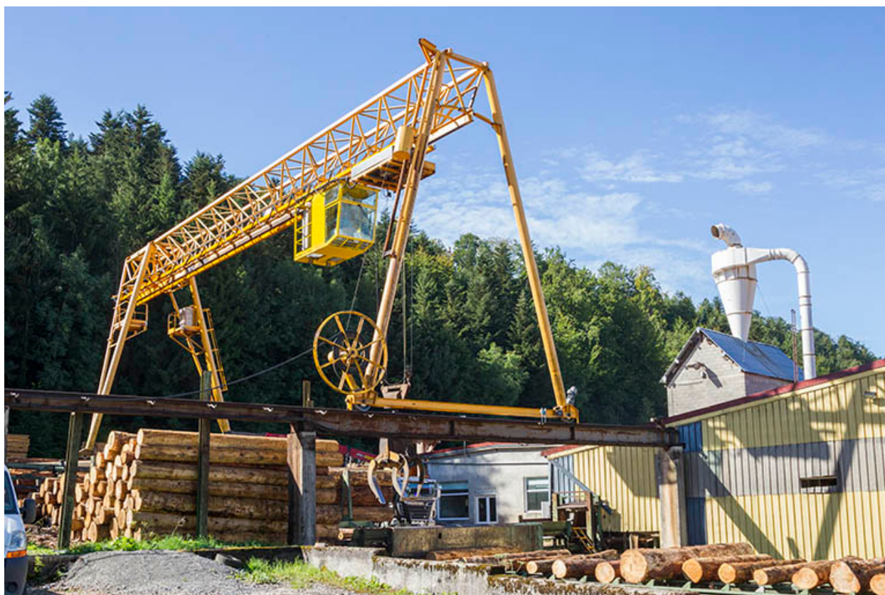
Le portique roulant sur son chemin de roulement. A droite l'atelier de débitage (M).
