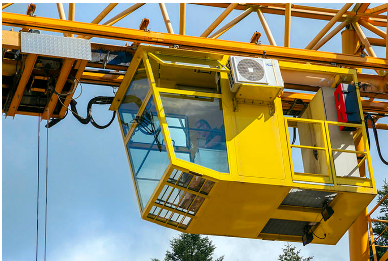
Portique roulant : cabine de commande.
