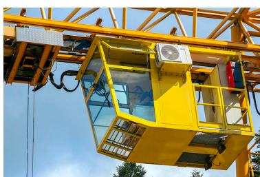
Portique roulant : cabine de commande. Phot. Yves Sancey IVR43_20132501722NUC2A
