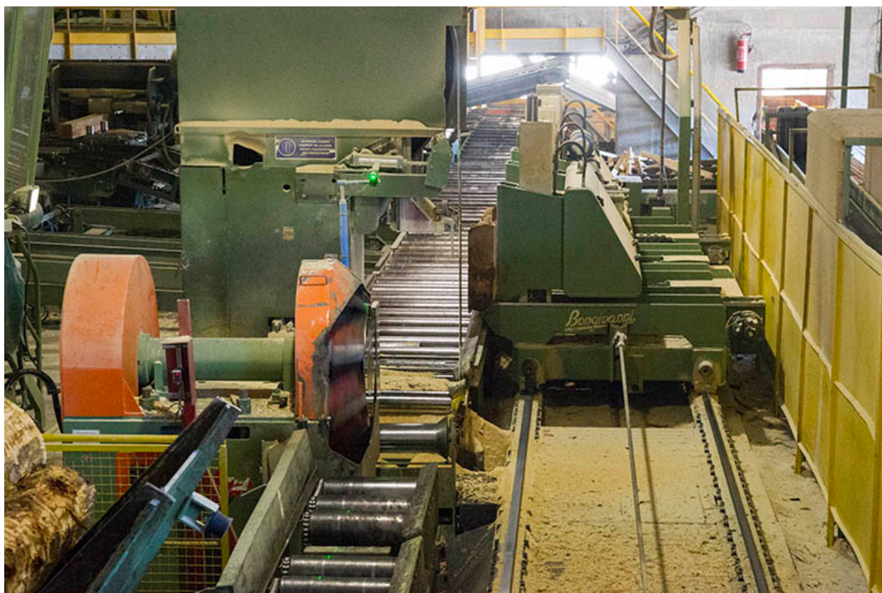
Atelier de débitage (N) : scie à ruban Bongioanni et son chariot, vus de l'amont.
