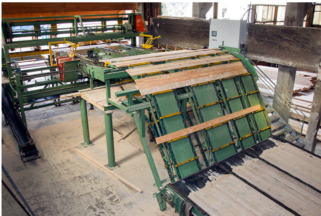
Atelier de triage et d'empilage (F) : empileuse.
