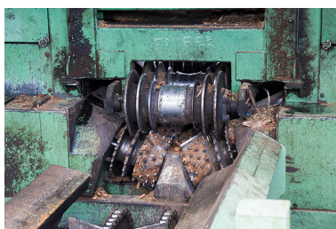
Installation de billonnage : détail des rouleaux. Phot. Yves Sancey IVR43_20132501749NUC2A
