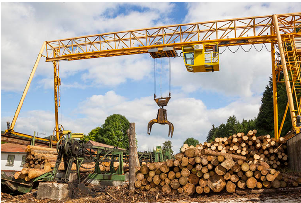
Portique roulant : déplacement de la pince.
