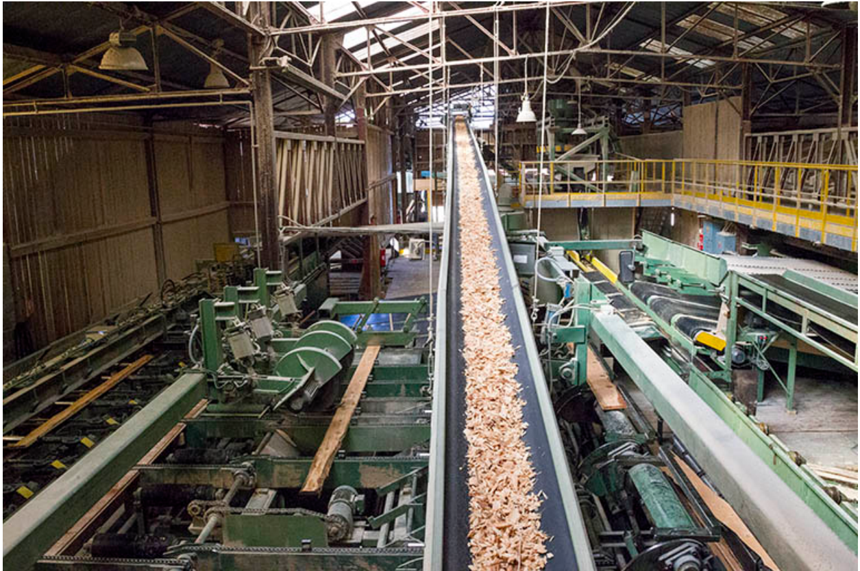
Ateliers de débitage (N et M) : machines de reprise et tapis roulant d'évacuation des sciures et des copeaux.
