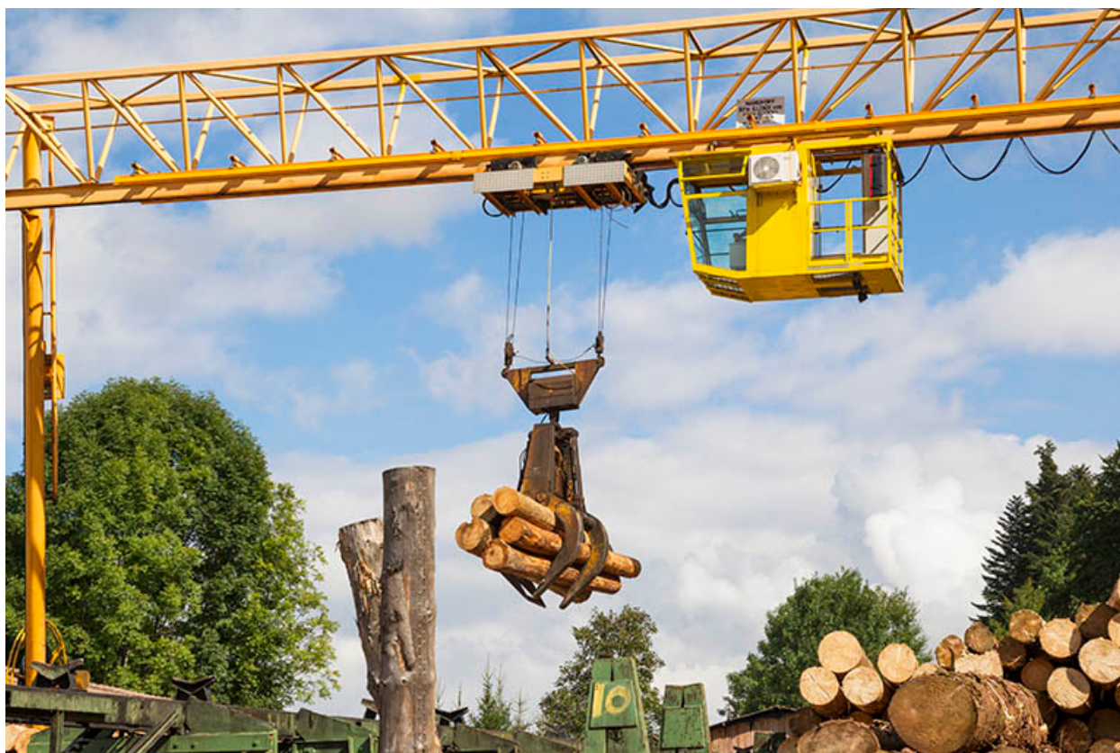
Portique roulant : transport de grumes.
