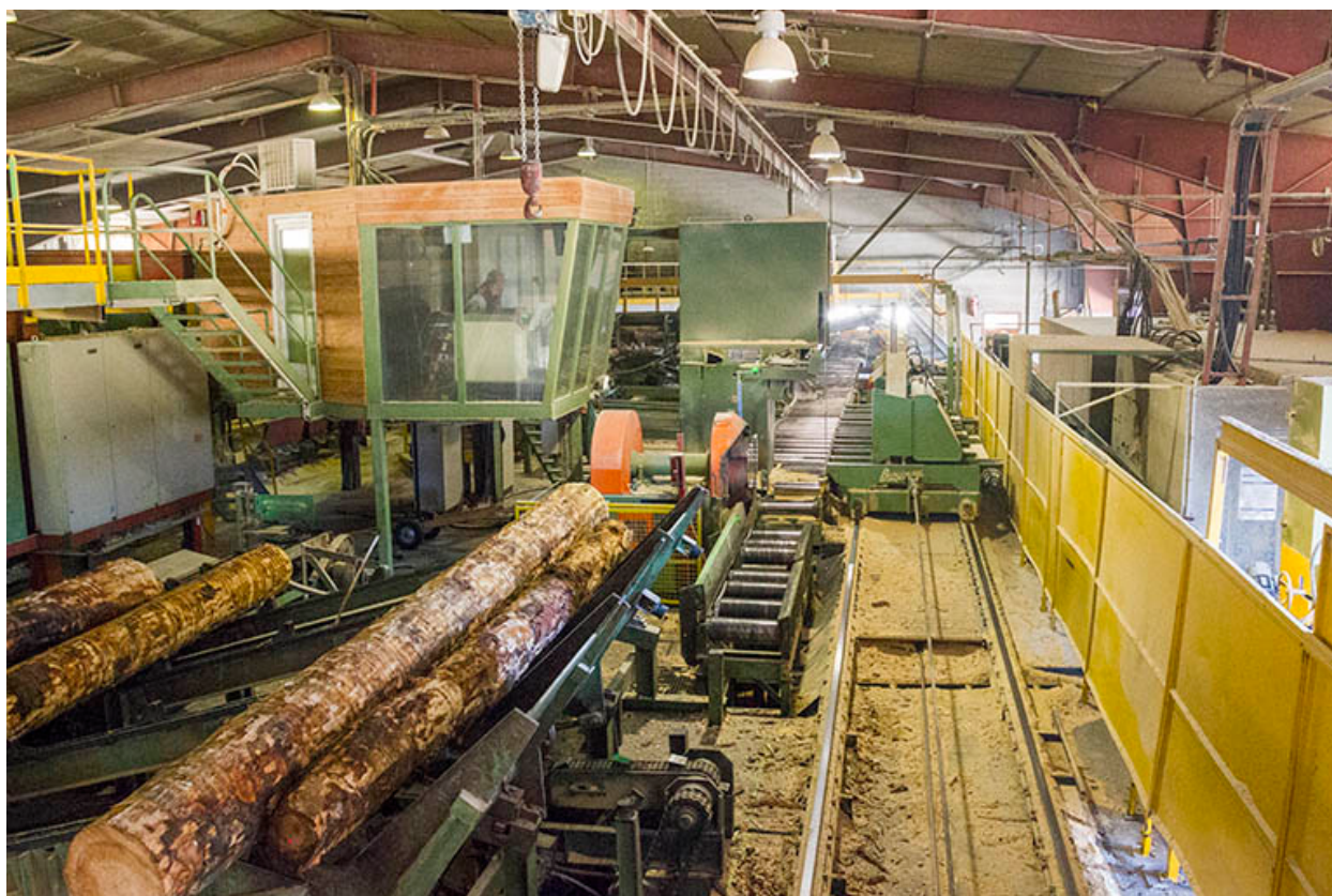
Atelier de débitage (N) : ligne ruban, pour les commandes diversifiées, vue de l'amont.
