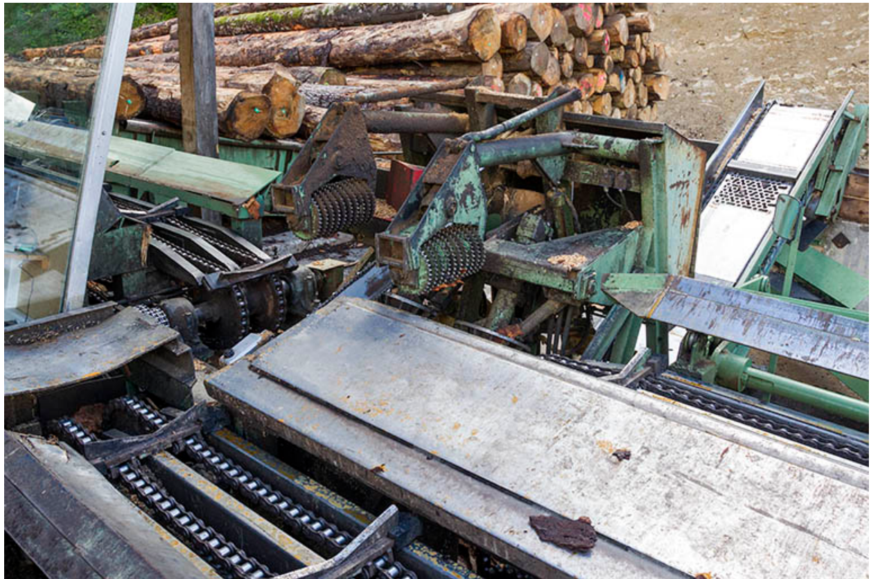
Installation de billonnage.
