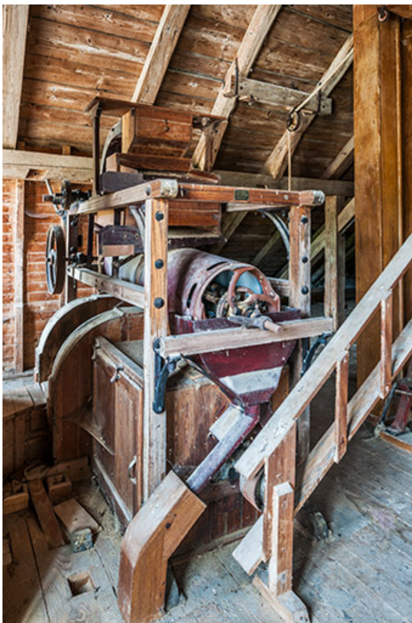
Etage de comble : trieur à grains Lhuillier.
