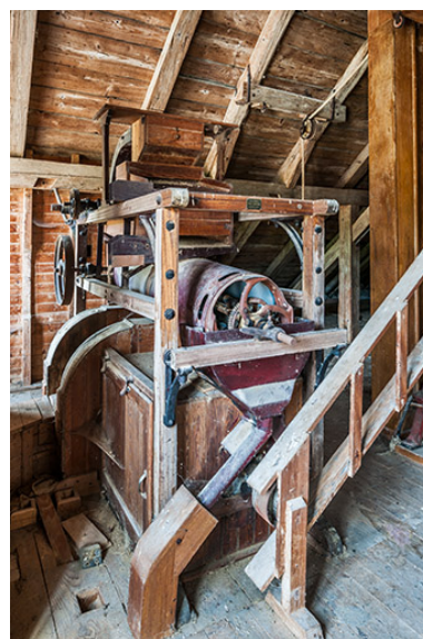
Etage de comble : trieur à grains Lhuillier. Phot. Jérôme Mongreville IVR43_20142501248NUC4A
