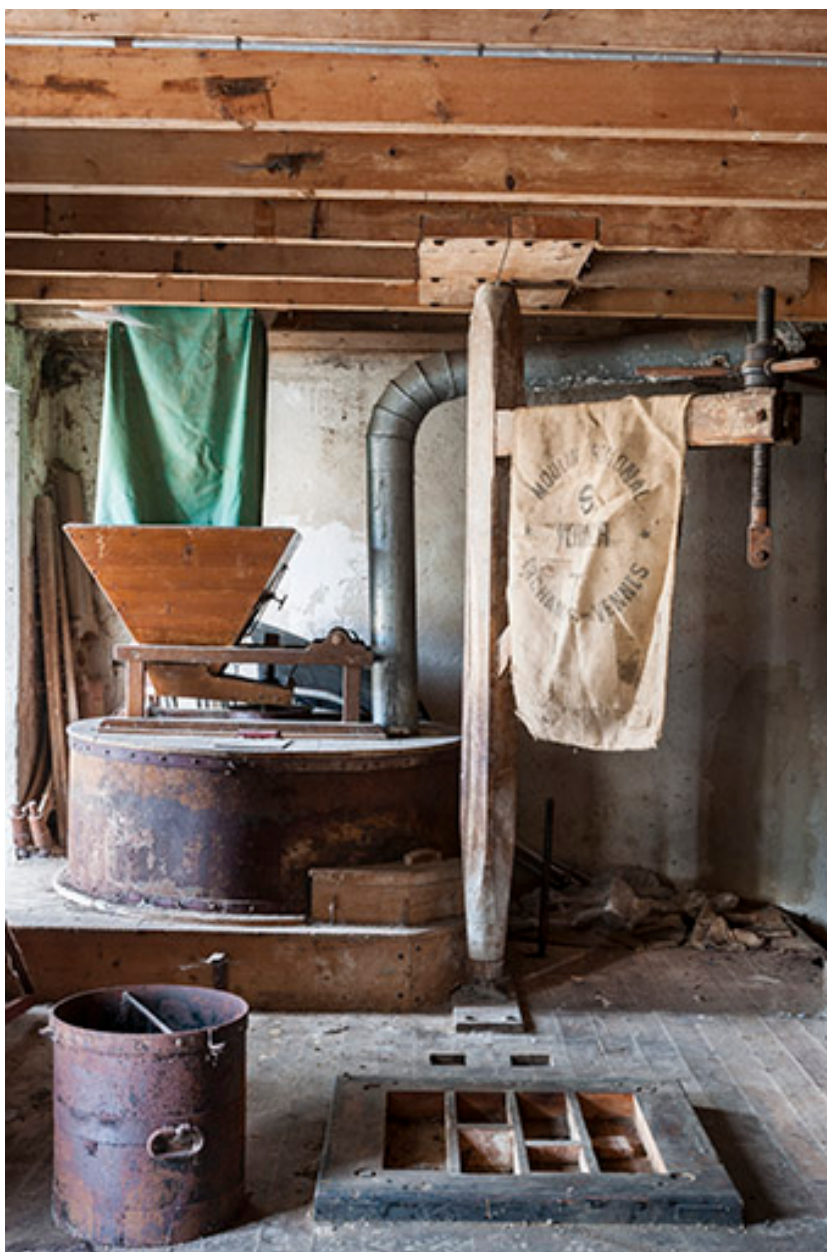
Rez-de-chaussée : une meule et sa potence.
