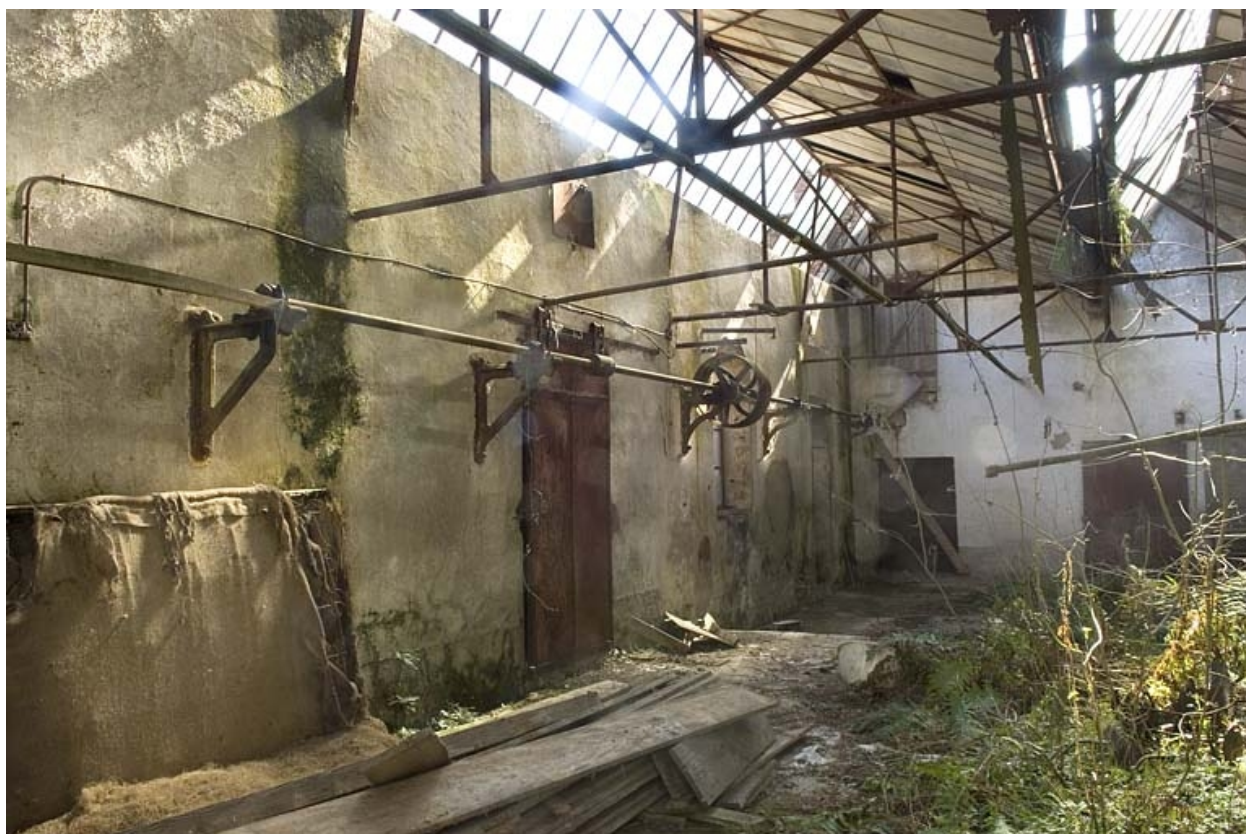
Atelier de fabrication. Charpente métallique et éléments de transmission.
